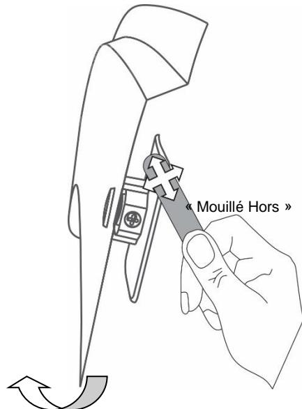
7. Soulevez doucement le visor de cadre de porte, la languette de protection sur l'adhésif sur socle est accessible. Tirez sur la feuille de protection du socle et appuyez fermement sur le pare-soleil sur le châssis de la porte. En utilisant le bois "wet" stick fourni, appliquer la pression à la surface de l'adhésif du socle. Cela fera en sorte qu'il
