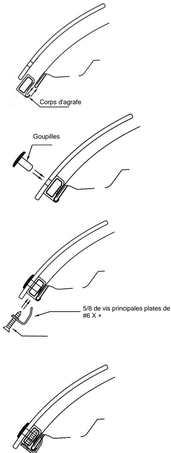
16. Placer un corps de pince au-dessus de chacun des plots du film anti-abrasion sur le bord de la hotte.
