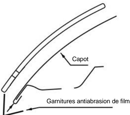
15. Peler et plier les quatre (4) grandes plages de films anti-abrasion à moitié sur le bord capot alignés avec les trous extérieurs de la déviation dans la zone au-dessus des phares.
