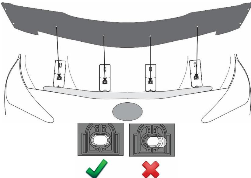
6. Placez le déflecteur de capot sur les socles pour confirmer le bon positionnement. Assurer les trous du déflecteur aligner avec celles des caissons. Si nécessaire, repositionner les socles afin que tous les postes d'attache sont corrects et le déflecteur est bien centré.
