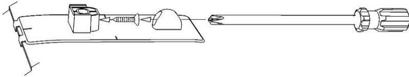
12. Insérer une vis à tête plate (5/8 po.) n° 6 dans chaque piédestal, puis la tourner en quelques mouvements. La pointe de la vis ne doit pas pénétrer dans le trou où l'épingle de fixation s'installera plus tard.
