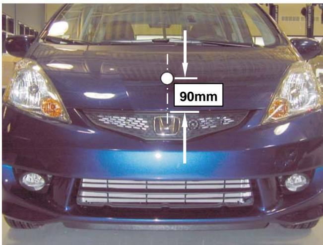
3. Ouvrir le capot. Éplucher et plier les tampons de film d'anti-abrasion dans la moitié au-dessus du bord du capot, dans les trois (3) endroits montrés dans l'illustration ci-dessous. Le premier endroit est le centre du bord de capot. Le deuxième et le troisième endroit correspondant **au deuxième trou rond (252mm)** à gauche et à droite du centre, comme indiqué dans l'illustration.
